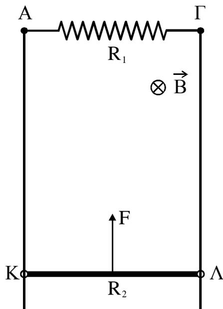
προς τα πάνω με αμελητέες τριβές και σταθερή ταχύτητα  $v=4\text{m/s}$  δεχόμενος την επίδραση σταθερής εξωτερικής δύναμης  $F$ , όπως στο σχήμα. Η όλη διάταξη βρίσκεται μέσα σε οριζόντιο ομογενές μαγνητικό πεδίο μέτρου  $B=1\text{T}$ , όπως στο σχήμα.
